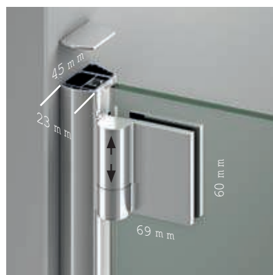
Cerco a pared + bisagra elevable 3mm. Apertura 90° exterior.
