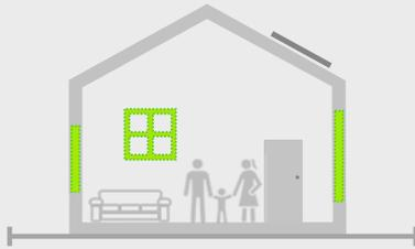
La carpintería de las puertas y ventanas es el punto débil de la construcción por las pérdidas de calor y frío que se producen por los marcos y las juntas. Deben de ser de las más altas prestaciones, con vidrios triples, cristales de baja emisividad, marcos y perfiles aislantes, juntas de doble estanqueidad, ... El diseño y la posición son también claves.
