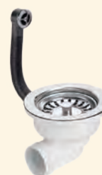
Válvula fregadero acodada ahorro espacio. Tapón cestilla acero inoxidable. Rebosadero circular.
