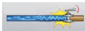
Cierre repentino (ocasiona el golpe de ariete)
