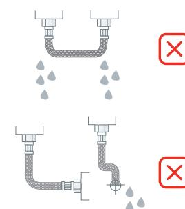
No instale flexibles en tensión o torsión
