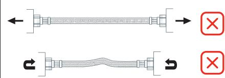
No aplicar una fuerza externa puntual o constante en el flexible una vez instalado (no dejar elementos apoyados o colgando del flexible).
