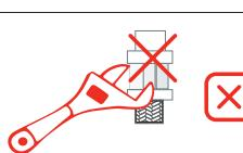
Conexionado a llave de corte para 3/8" y 1/2": Roscar a mano y ajustar media vuelta con llave apropiada. Compruebe que no hay fuga. En caso que la hubiera, vuelva a apretar ligeramente con la llave.
