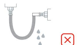
Respetar el radio de curvatura mínimo indicado específicamente para cada diámetro.
