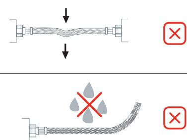
Un contacto prolongado con productos de limpieza, líquidos usados para facilitar la soldadura o sustancias químicas agresivas puede dañar la superficie y provocar el deterioro del flexible.
