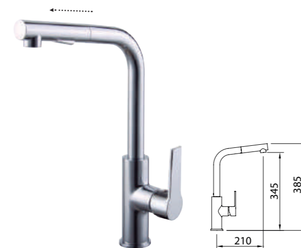
Mezclador con aireador, caño giratorio, ducha extraíble con pulsador para lavavajillas, enlaces de alimentación flexibles M-10 3/8" x 370 mm. Mixer with aerator, swivel spout, pull-out handset and flexible hoses M-10 3/8" x 370 mm. Mitigeur évier bec orientable, aérateur, douchette extractible avec poussoir pré-lavage, raccords flexibles M-10 3/8" x 370 mm
