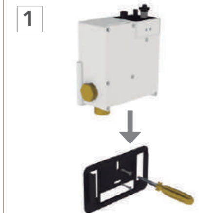
Sujeción caja pared Wall box fixing / Fixation de la boîte murale • Platina sujeción caja pared incluida Enclosure wall box included Boîtier mural inclus
