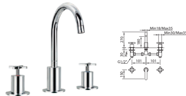
Grifería mezcladora de repisa con aireador, caño alto 180mm. Three-hole basin mixer with aerator spout 180mm. Mélangeur lavabo 3 trous, aérateur
