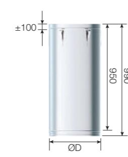
Tubo descenso | Down piping | Élément descente 1000 mm
