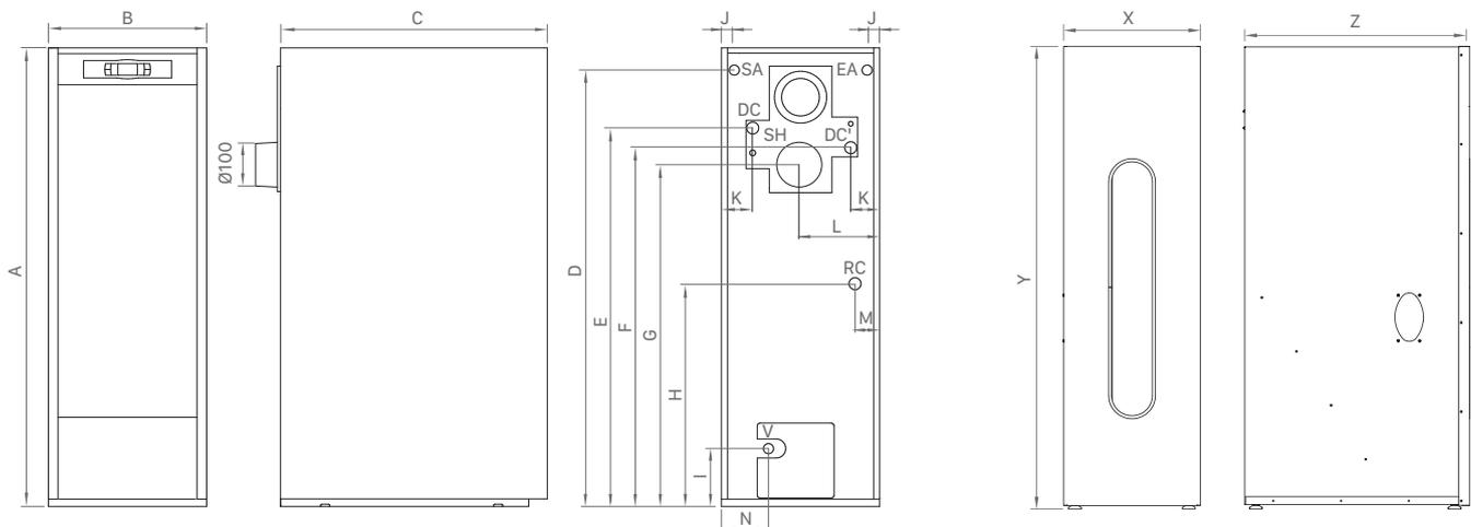
DC: Ida calefacción      V: Vaciado      SA: Salida ACS
