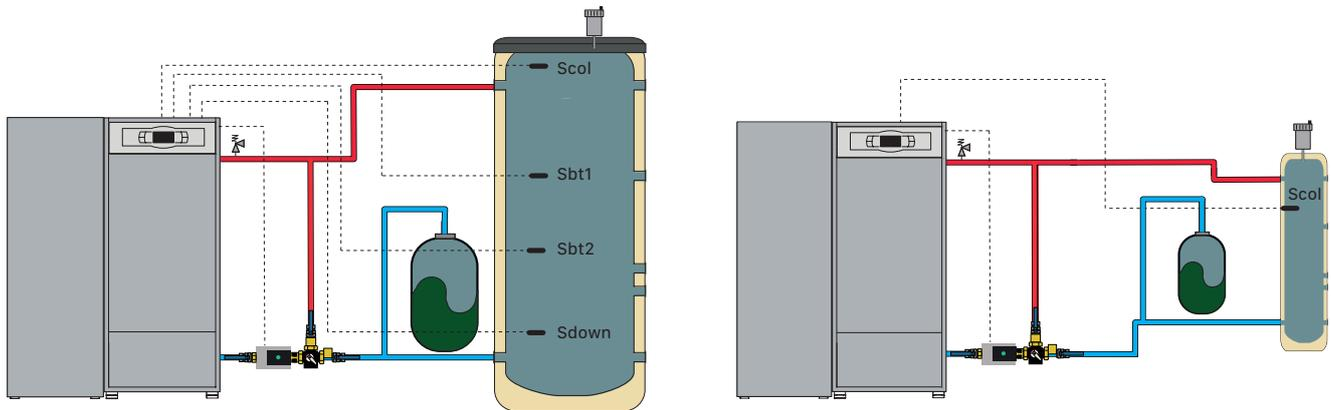
Scol: Sonda de temperatura superior o del colector
