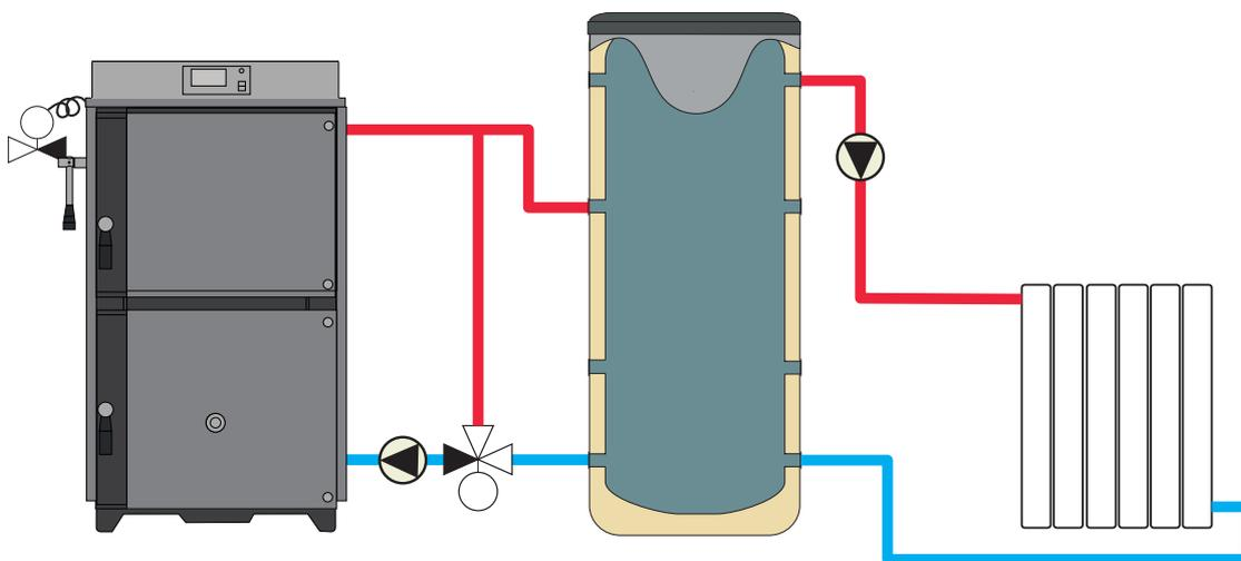
El PACK UNIT LG BT incluye además del sistema anticondensados un depósito de inercia BT. En este depósito se acumula agua del circuito primario que permite el control de la instalación con regulaciones sobre la temperatura ambiente o combinaciones de circuitos a diferente temperatura de impulsión.
