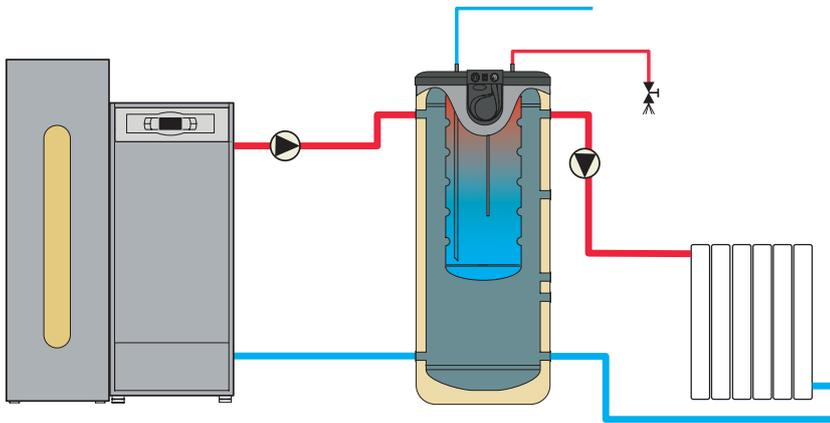
El PACK UNIT BC BT DUO incluye los componentes necesarios para dar servicio de calefacción y agua caliente sanitaria por acumulación con una caldera a pellet BIOCLASS HC. La producción de agua caliente sanitaria se consigue por medio de un acumulador inoxidable integrado en el depósito de inercia BT DUO. Simultáneamente en este depósito se acumula agua del circuito primario que ahorra en el consumo de combustible al reducir los ciclos de encendido y apagado de la caldera.
