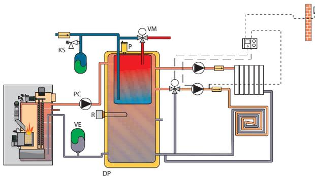
Caldera BIOCLASS IC con depósito de inercia BT DUO para un circuito de suelo radiante, un circuito directo y ACS.
