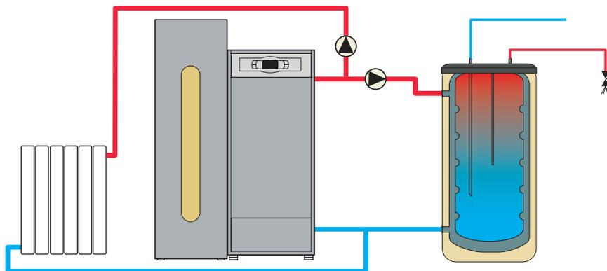
El PACK UNIT BC SANIT se compone de la caldera Bioclass, el depósito de reserva de pellet, la sonda para uso prioritario del agua caliente sanitaria y un interacumulador SANIT fabricado en acero inoxidable y doble envolvente con una gran producción de agua caliente sanitaria.
