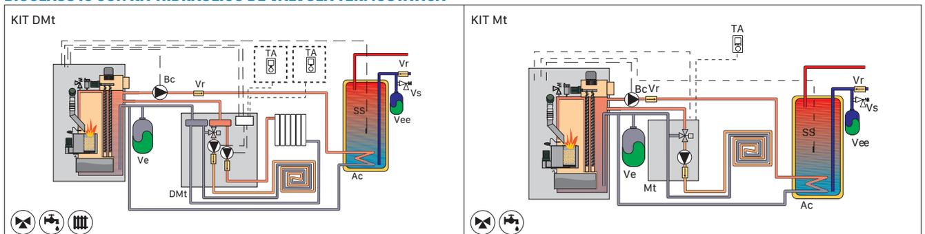
**BIOCLASS IC CON KIT HIDRÁULICO BIO Y SONTA EXTERIOR**
