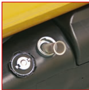
Filtro para llenado del depósito de gasoil
