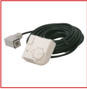
Termostato ambiente +5/+30°C, con cable L = 10 m., y clavija a 90°. Para GA y GA/N
