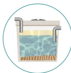
separadores de grasas
