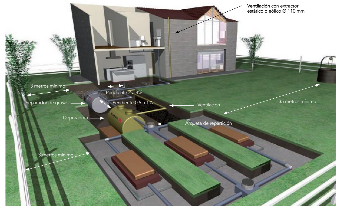
Esquema según la norma CEN EN 12566-2
