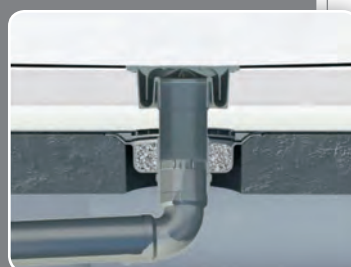
rellenar en el interior de la caldereta con gravilla para que haga de filtro e impida la colmatación
